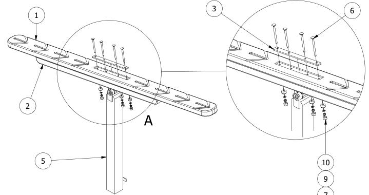
2. THE UNDERSIDE TIMBER IS OFF CENTRE TO ALLOW THE BALANCE BEAM TO FALL BACK TO THE START POSITION: ENSURE THE LONGER SIDE OF THE LOWER BOARD IS ON THE LEFT SIDE OF THE ARROW AS ILLUSTRATED BELOW.
