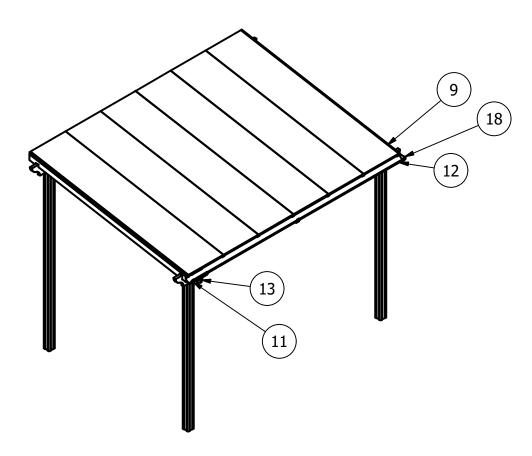
5. AS SHOWN POSITION BELOW, POSITION AND SECURE THE GUTTER DOWN PIPE TO THE POST USING THE BRACKETS, FIXINGS AND ANGLED DOWNPIPES SUPPLIED.
