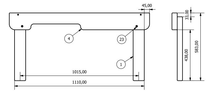
2. SECURE THE BACK PANEL AND BACK TOP PANELS TO THE BACK LEGS AS ILLUSTRATE BELOW TO CREATE THE BACK FRAME.
