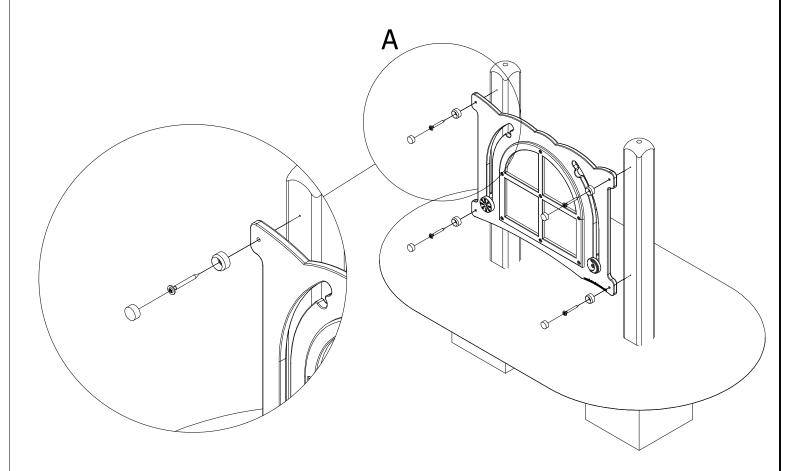
2. POSITION THE UNIT IN THE FOUNDATION HOLES ENSURING THE GROUND LEVEL IS INLINE WITH THE GROUND MARKING ON THE POSTS.
