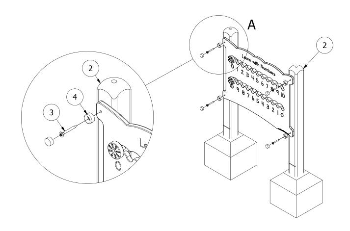
2. POSITION THE UNIT IN THE FOUNDATION HOLES ENSURING THE GROUND LEVEL IS INLINE WITH THE GROUND MARKING ON THE POSTS.
